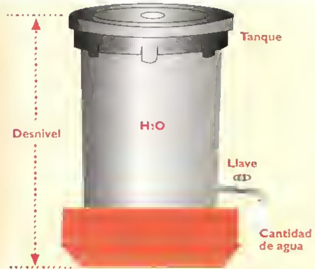
Figura 4.19. Tanque de reserva de agua
